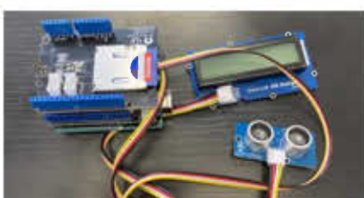
図-3 自作したArduino水位計
