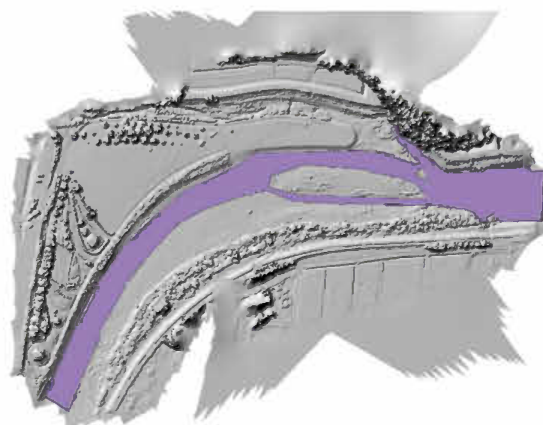
図2. ドローンで取得した地表高マップ
