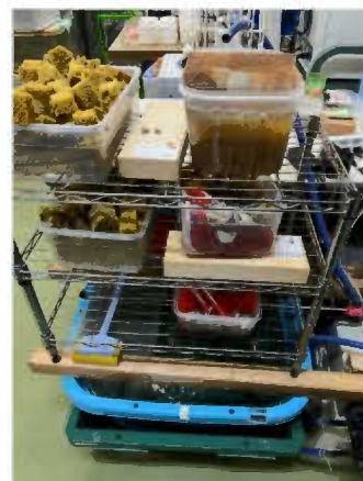
水質浄化装置 (傾斜土槽法)
