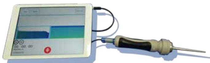
▲ 聽音装置(タブレット端末+マイクロフォン)
