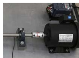
▲ 機械の動作音を発生させる実験装置
