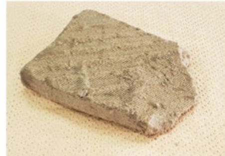
写真-1 エスエスゲン処理した浄水汚泥
