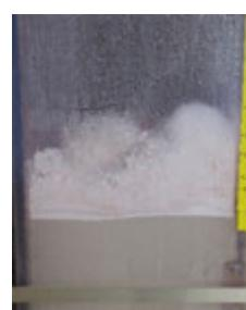
図4 浮上分離槽に堆積したスカム
