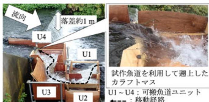
図4 試作魚道システムと遡上の様子
